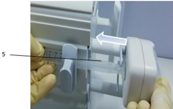
6. Afloje el mango de descarga presionado, se cerrará la traba de la varilla y se fijará el extremo del pistón de la jeringa, como muestra la figura:
